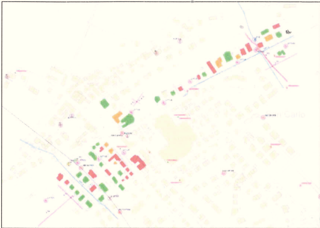
Figura A4.2 – Classi di danno degli edifici nelle aree con problemi geotecnici.
